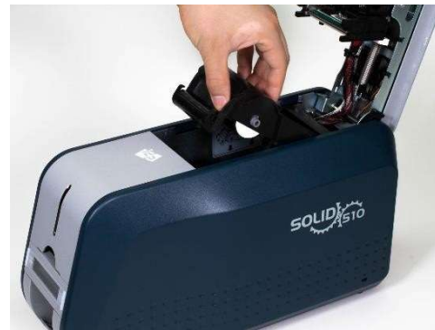
Рис. 19 Установка съемного картриджа с лентой
